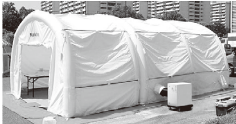
空調も完備した外来診察室“陰圧テント”
